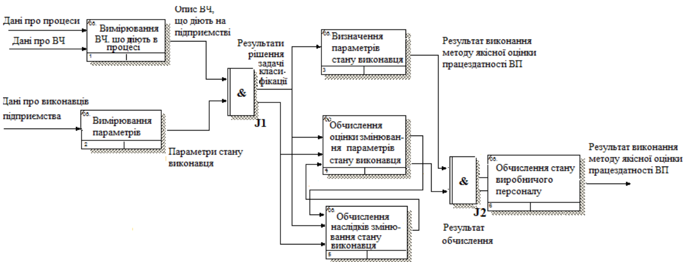
Рисунок 1 – IDFE3-модель взаємодії процесів інформаційної технології моніторингу стану виробничого персоналу підприємства
